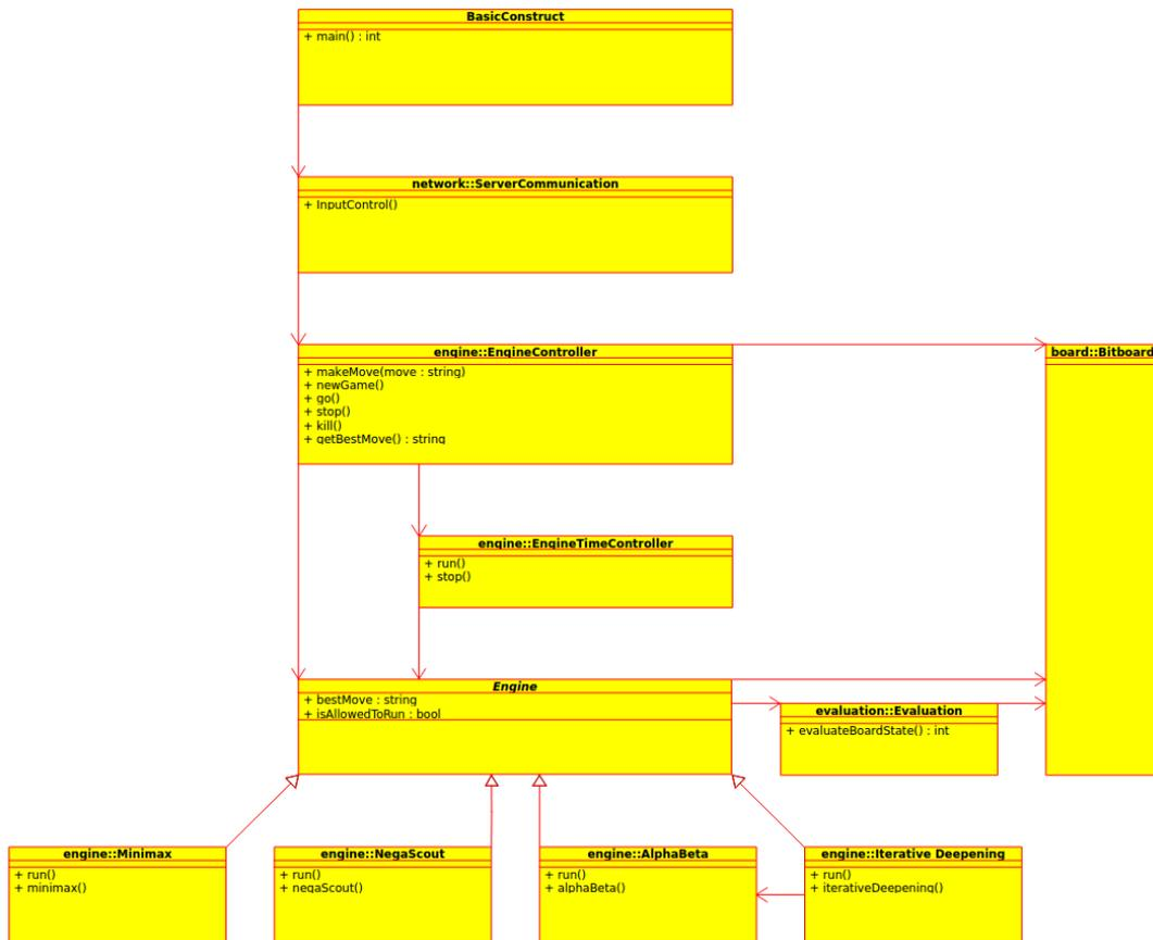
Abbildung 9: UML-Diagramm zur Abbildung der gewählten Klassenstruktur
